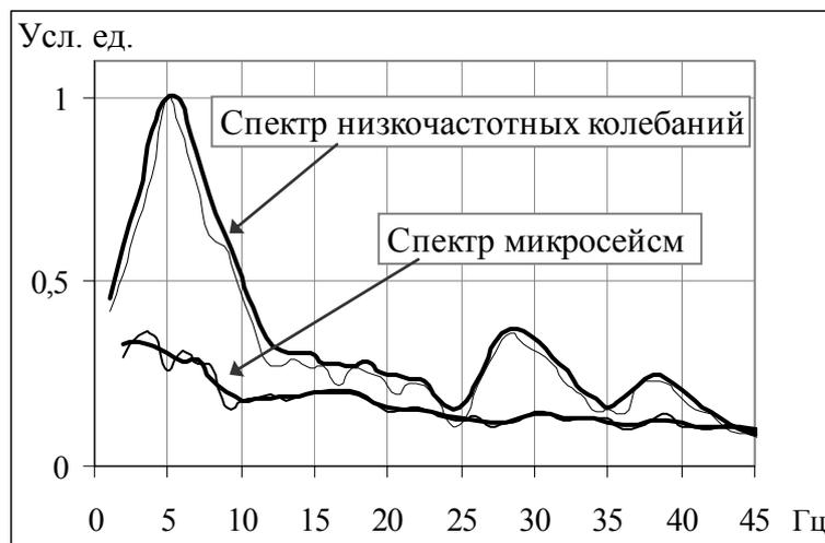
Рис. 2. Обобщенные спектры низкочастотных сейсмических колебаний и микросейсм над областью очистных работ
