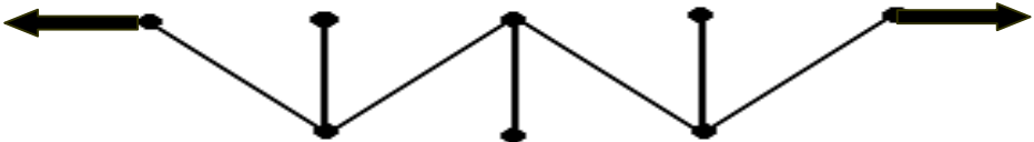
Рис. 11. Фрагмент фрактальной структуры с отрицательным коэффициентом Пуассона.
