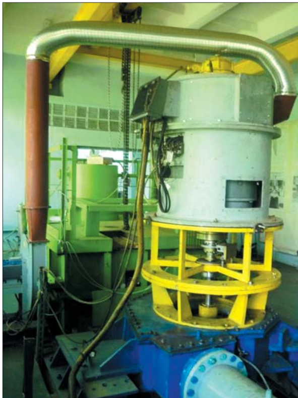
Швидкохідна насос-турбіна для ГАЕС потужністю 200 МВт
