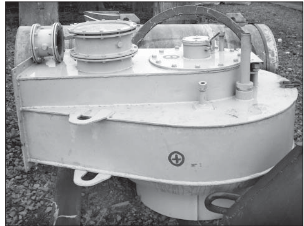
Рис. 9. Корпус та канал модернізованої частини пальника з ТХП
