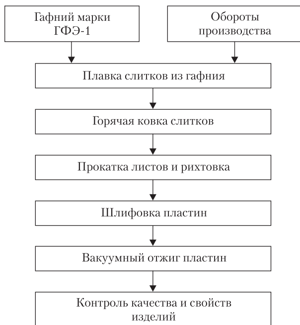
Рис. 1. Укрупненная схема производства пластин из гафния
