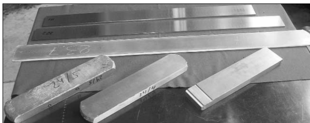
Рис. 4. Заготовки пластин гафния послековки, после механической обработки поверхности; прокатанная полоса, а также шлифованные и обрезанные пластины
