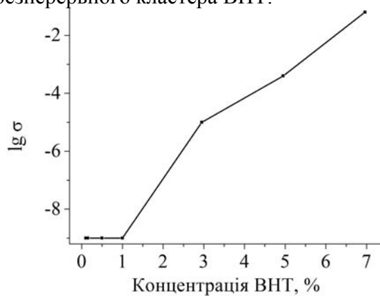
Рис. 5. Залежність логарифма електропровідності \sigma ( \text{Ом}^{-1} \text{см}^{-1} ) для системи ПП-ВНТ від концентрації ВНТ на частоті 1кГц за t=20^\circ\text{C} .
