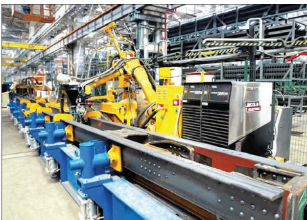
Роботизированный комплекс для сварки под флюсом хребтовых балок полувагонов
