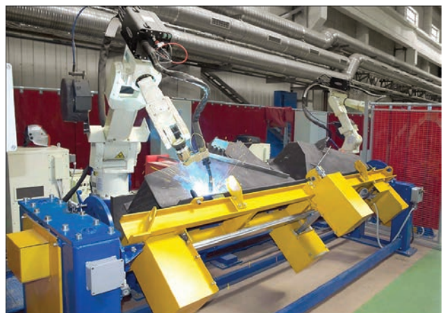
Роботизированный комплекс сварки промежуточных балок вагонов
