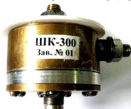
Рис. 1. Внешний вид усовершенствованного коаксиального дискового шунта типа ШК-300М1, предназначенного для измерения в микро- и миллисекундном диапазонах затухающих синусоидальных и аperiodических импульсов тока искусственной молнии амплитудой до \pm 220 кА в сильноточной разрядной цепи мощного высоковольтного ГТМ с интегралом их действия до 3 \cdot 10^6 Дж/Ом [10]
