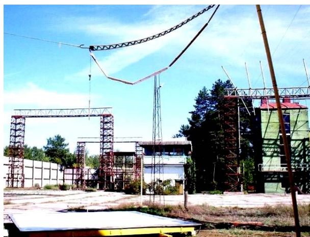
Рис. 14. Общий вид сверхвысоковольтного омического делителя напряжения типа ОДН-2,5 на номинальное напряжение \pm 2,5 МВ, подсоединенного в разрядной цепи ГКИН к двухэлектродной системе «игла-плоскость» с длиной воздушного промежутка 3 м (верхний стальной стержень-электрод этой электроразрядной системы размещен по центру ее нижнего плоского электрода, выполненного из тонкой оцинкованной стали с размером в плане 5 м \times 5 м) [23]
