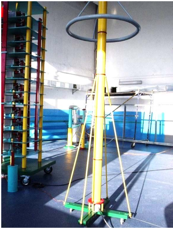
Рис. 10. Общий вид передвижного сверхвысоковольтного омического делителя напряжения типа ОДН-1,2 на номинальное напряжение \pm 1,2 МВ, размещенного на заводском испытательном поле высоковольтного испытательного стенда СВИ-1,2, предназначенного для определения в лабораторных условиях импульсной электрической прочности полимерной изоляции собственного производства (предприятие ES «Полимер», г. Бахмут, Украина, 2006 г.) [9, 17]
