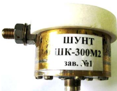
Рис. 2. Внешний вид усовершенствованного коаксиального дискового шунта типа ШК-300М2, предназначенного для измерения в согласованном режиме работы его кабельной линии передачи сигнала в микро- и миллисекундном диапазонах импульсов тока искусственной молнии амплитудой до \pm 220 кА в сильноточной разрядной цепи высоковольтного ГТМ с интегралом их действия до 15 \cdot 10^6 Дж/Ом [11]
