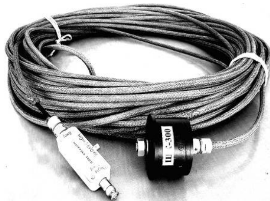
Рис. 4. Внешний вид измерительного шунта типа ШК-300М1, подсоединенного ко входу дополнительно экранированного коаксиального радиочастотного кабеля марки РК 75-7-11 длиной 70 м, выход которого подключен к экранированному согласующему делителю напряжения типа СДН-300 с двумя выходными коаксиальными разъемами 1:1 и 1:2 для согласованного подсоединения к ним измерительных каналов трех ЦЗО (например, серии Tektronix TDS 1012) при одновременной регистрации в сильноточной разрядной цепи ГТМ сразу трех компонент полного импульса тока искусственной молнии с различными АВП [6, 10]
