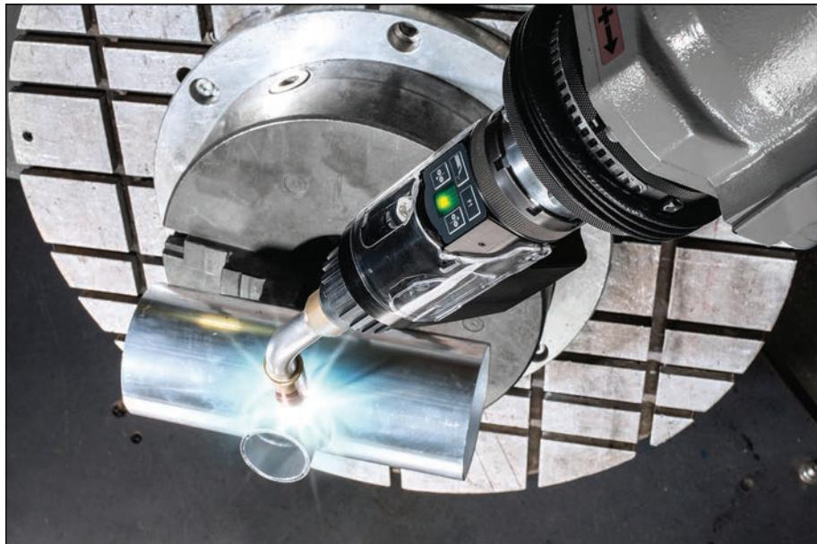
Компактная конструкция горелки для роботизированной сварки Robacta Drive TPS/i и реализованные в ней передовые инженерные решения позволили повысить доступность компонентов и точность TCP
