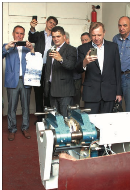
Прессовая сварка магнитоуправляемой дугой неповоротных стыков труб
