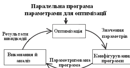
Рис. 3. Цикл роботи авто-тюнера
