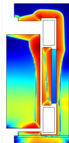
Рис. 8. Распределение модуля индукции в магнитопроводе
