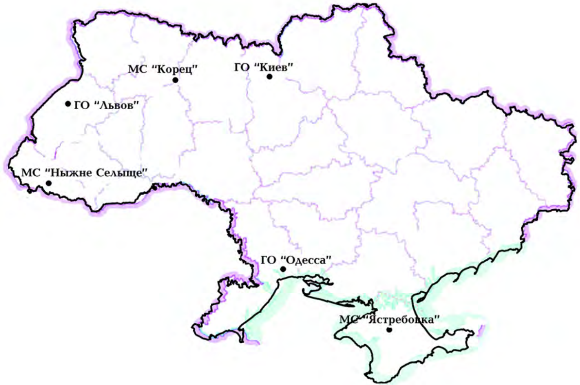
Рис. 1. Сеть магнитных станций Института геофизики НАН Украины (МС — магнитная станция, ГО — геофизическая обсерватория с магнитной станцией).
