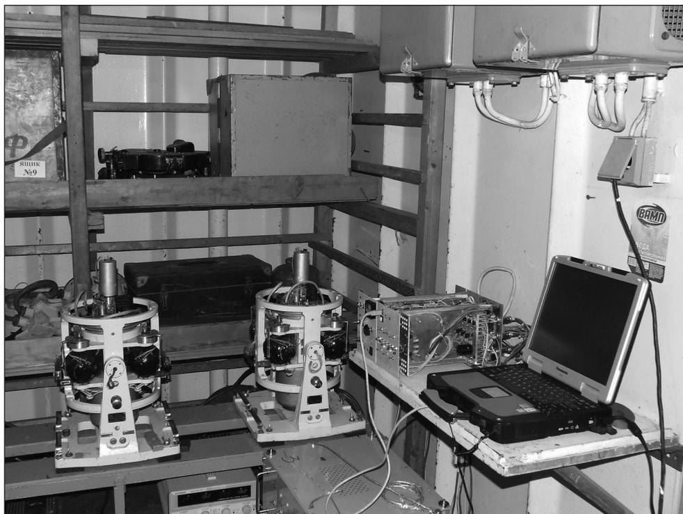
**Рис. 4.** Забортная часть магнитометрического модуля
