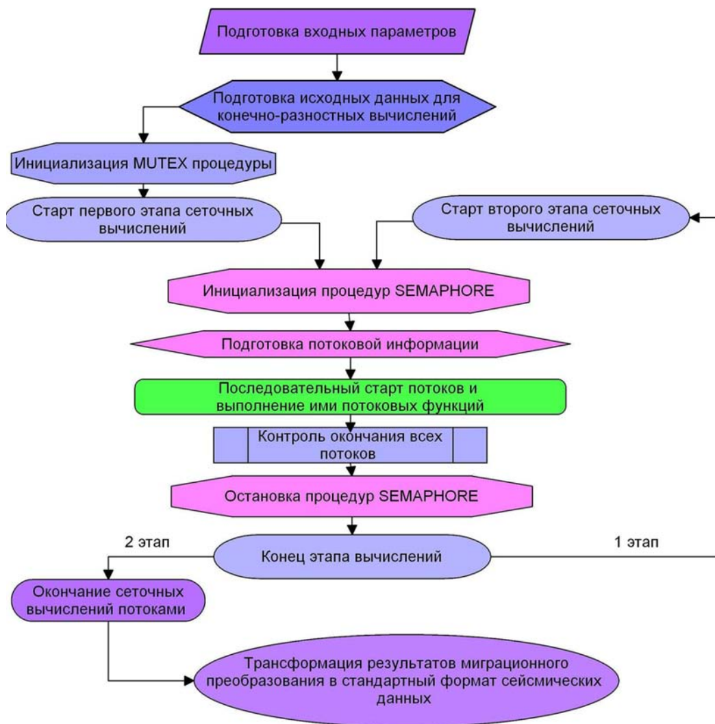
Рис. 2. Общая блок-схема вычислительного процесса при трехмерной конечно-разностной миграции после суммы с распараллеливанием на нескольких процессорах
