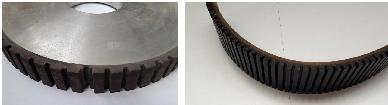
Рис. 3. Стрічка типу АСШЛ на різних етапах виготовлення шліфувального круга діаметром 300 мм
