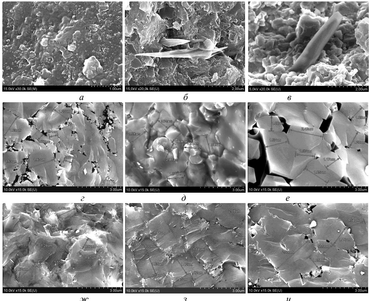
Рис. 2. Микроструктура образцов карбида бора  $B_4C$  (E) (a),  $B_4C$  (A) (б, в,) и  $B_4C$  (S) (г–и), спеченных при давлениях 4 ГПа (а–е), 7,7 ГПа (ж–и) и температурах, °C: а – 1400; г, ж – 1600; б, в, д, з – 1800; е, и – 2000
