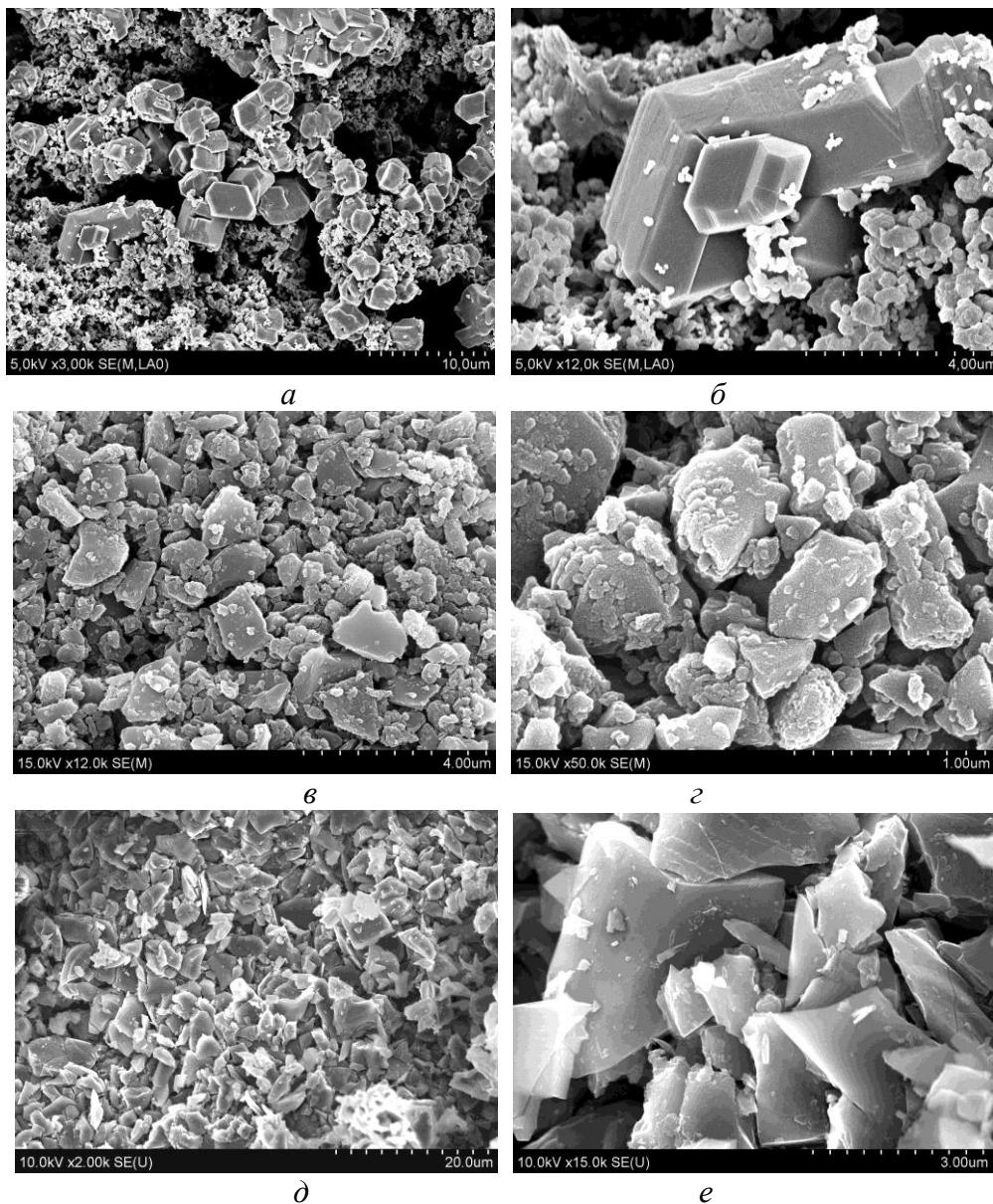
Рис. 1. Электронно-микроскопические изображения порошков карбида бора при различном увеличении: *а* ( $\times 3000$ ), *б* ( $\times 12000$ ) – В<sub>4</sub>С (Е); *в* ( $\times 12000$ ), *г* ( $\times 50000$ ) – В<sub>4</sub>С (А) и *д* ( $\times 2000$ ), *е* ( $\times 15000$ ) – В<sub>4</sub>С (S)
