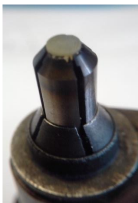
Рис. 7. Монокристалл природного алмаза, подготовленный к эксперименту
