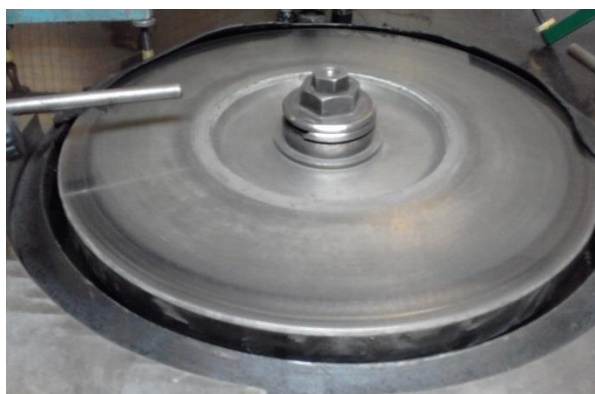
Рис. 8. Ограночный диск, шаржированный для эксперимента
