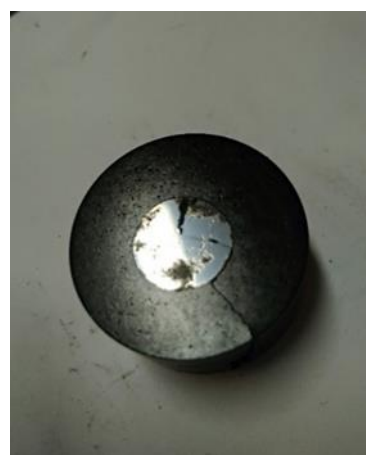
Рис. 3. Залежність значень модуля Юнга для зразків на основі cBN з різним вмістом мікрочолокон карбїду кремнію від температури спікання (а); зовнішній вигляд зруйнованого зразка (складу 50% cBN, 45% TaN, 5% Al) (б)
