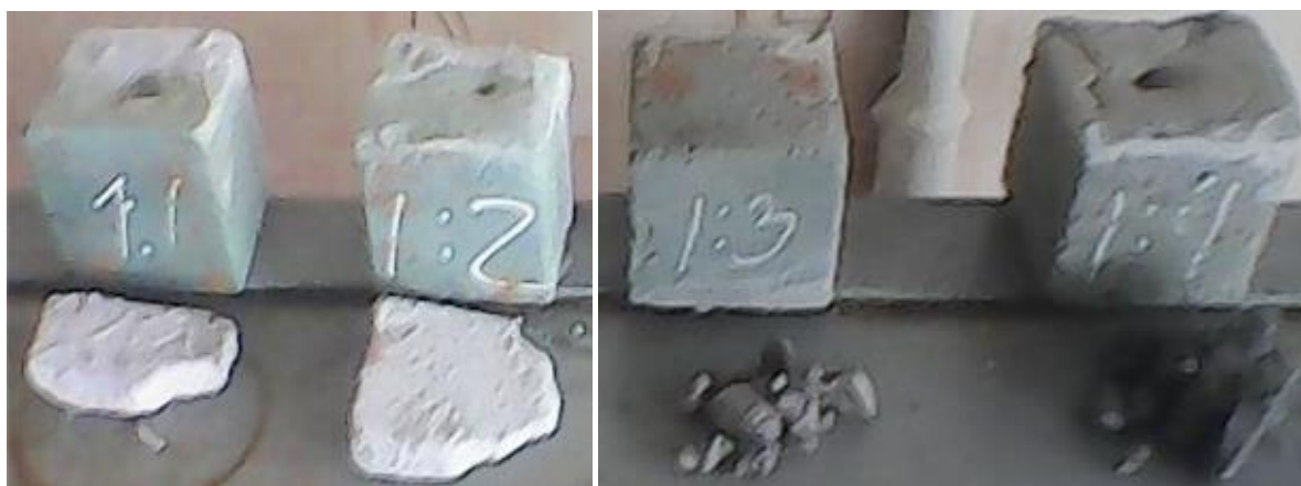
Рис. 1. Образцы тампонажного камня после их истирания на стенде
