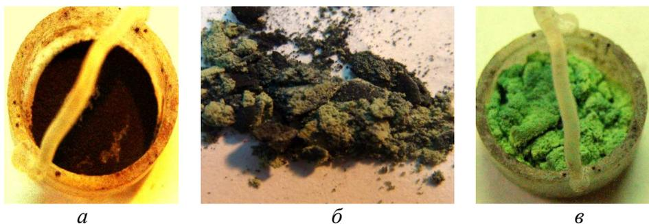
Рис. 12. Снимки металлического порошка вольфрама в процессе окисления парами воды: *а* — исходный; *б* — в промежуточном состоянии при достижении степени окисления ~0,7; *в* — при достижении суммарной степени окисления ~0,97.
