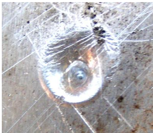
Рис. 17. Внешний вид внутренней зоны сквозного проплавления образца из алюминиевого сплава А0М толщиной 4 мм от совместного воздействия на него импульсной А- и длительной С- компонент тока искусственной молнии
