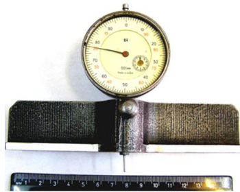
Рис. 7. Внешний вид специального микрометра, примененного при определении глубины проплавления h_n в листовых образцах алюминиевой обшивки ЛА от поражающего действия на них в воздухе СПК тока искусственной молнии
