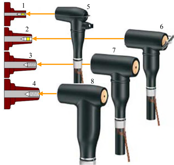
Рис. 12. Прхідні ізолятори (1 – 4) та кабельні адаптери (5 – 8): 1 – серія 200, втичні, 200А; 2 – серія 400, втичні, 400А; 3 – серія 400, нарізні, 400А; 4 – серія 600, нарізні, 630А; 5 – SOC 250 STP; 6 – SOC 400-1(2); 7 – SOC 630-1(2); 8 – SOC 630-3(4, 5).
