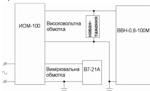
Рис. 1. Схема експериментального дослідження трансформатора ИОМ-110/25 з навантаженням
