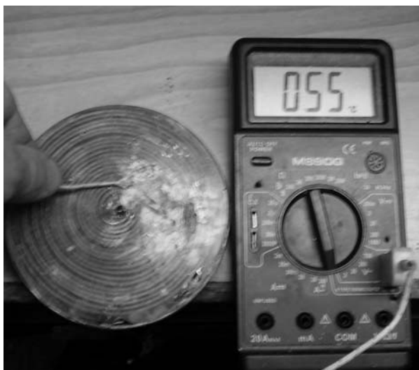
Рис. 13. Измерение температуры обмотки индуктора термопарой
