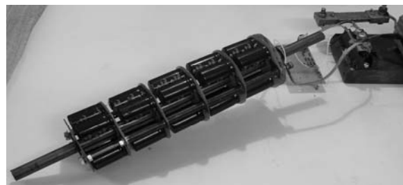
Рис. 2. Общий вид емкостного накопителя ( C = 20 \times 330 = 6600 мкФ) с токовым шунтом
