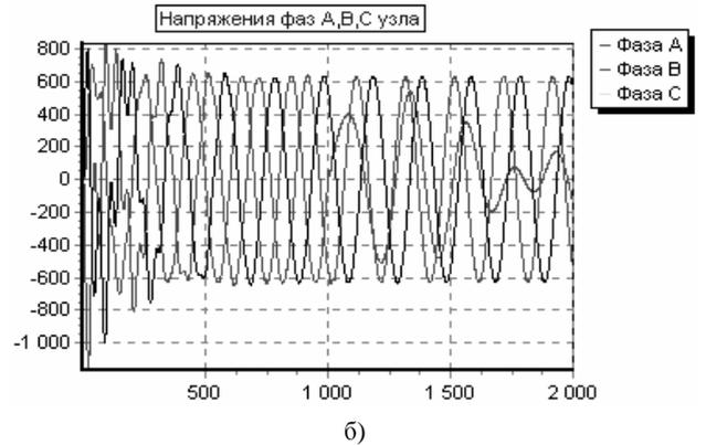
Рис. 2. Напряжения фаз в начале (а) и конце (б) ВЛ при включении на XX
