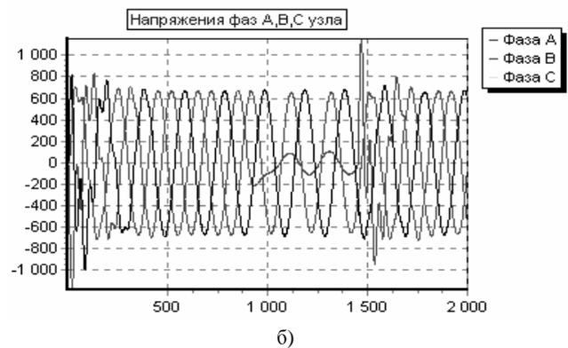
Рис. 4. Напряжения фаз в начале (а) и конце (б) ВЛ при ОАПВ (P=150 мВт)
