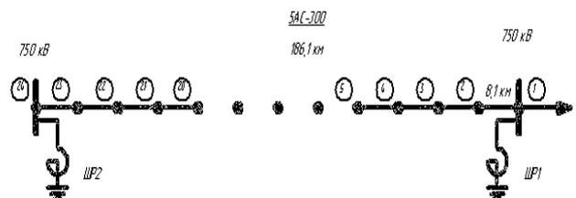
Рис. 1. Расчетная схема электропередачи
