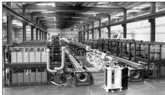
Рис. 7. Експериментальний багатосекційний рейкотронний прискорювач на енергію 32 МДж
