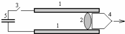
Рис. 3. Схематична будова рейкотронного імпульсного прискорювача: 1 – електроди-рейки; 2 – якір; 3 – комутатор; 4 – прискорювальний об'єкт; 5 – ємнісний накопичувач
