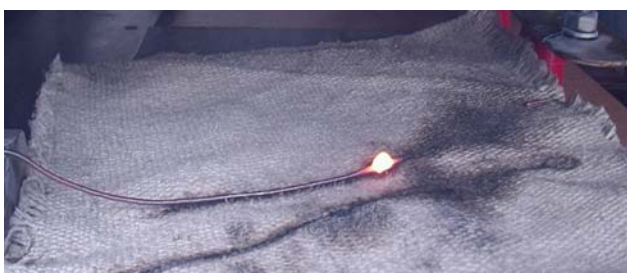
Рис. 7. Общий вид остывающих макроскопических "горячего" (бывшей зоны ВЭП по центру провода) и "холодного" продольных участков провода ( n \approx 2 )
