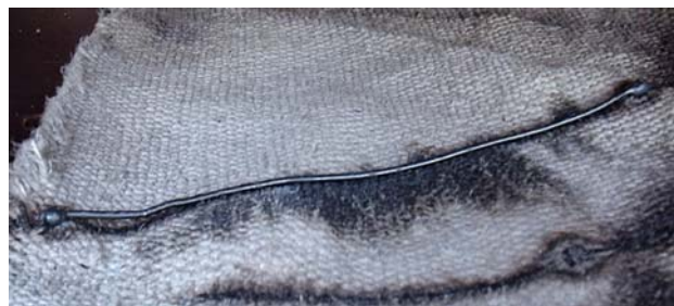
Рис. 5. Общий вид остывших макроскопических "горячих" (бывших двух зон ВЭП на краях провода) и "холодных" продольных участков провода ( n \approx 1 )
