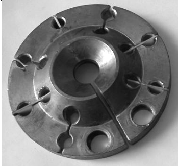
Рис. 1. Экспериментальный вариант индуктора для притяжения
