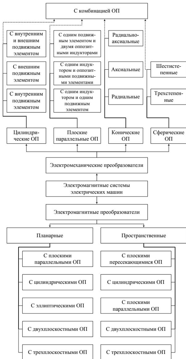
Рис. 1. Диаграмма обобщенной классификации электромагнитных систем электрических машин
