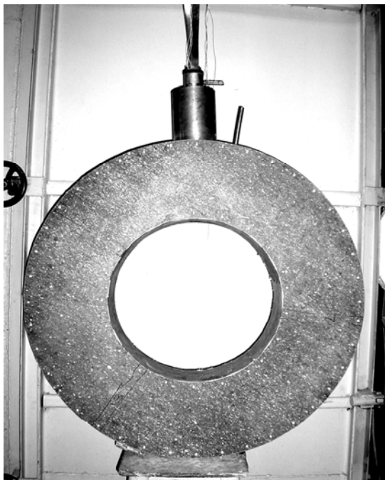
Рис. 3. Фото соленоида (вверху на патрубке видны токовводы, рядом трубка для залива криогента)
