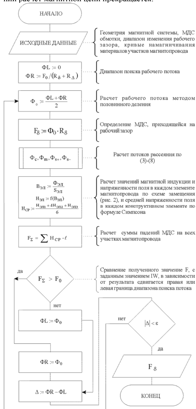
Рис. 3. Алгоритм расчета F_\delta по схеме замещения
