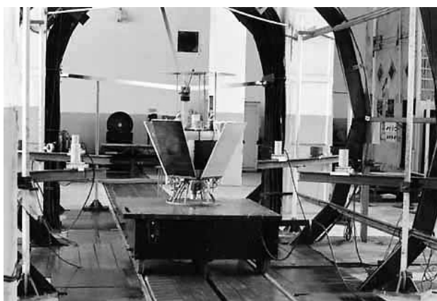
Рис. 2. Стэнд Отделения магнетизма Института электродинамики НАН Украины для измерений магнитного поля
