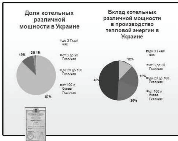
Рис. 5. Доля котельных разной мощности в Украине и их вклад в производство тепловой энергии.
