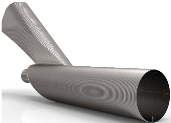
Рис. 5. Узел закрутки потока в металлической облицовке Ø 16 м. Рогунская ГЭС, Таджикистан
