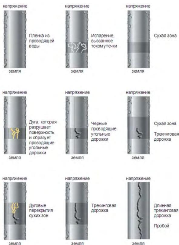
Рис. 5. Образование трекинговых дорожек на поверхности концевых муфт [4].
