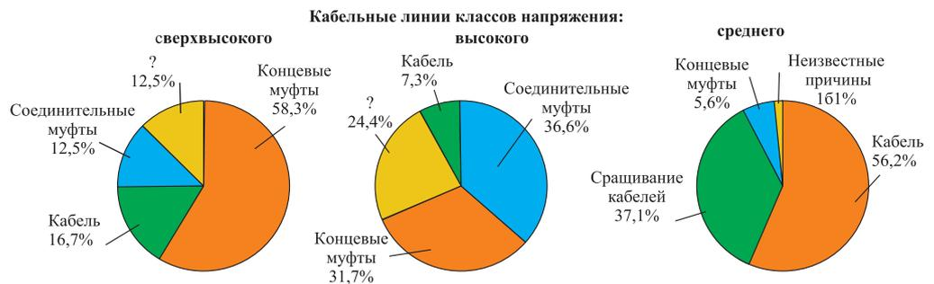
Рис. 3. Причины аварий и повреждений кабельных линий различного класса напряжения [8, 9]. Диаграмма справа представляет статистику повреждений кабельных линий среднего напряжения в Северной Америке.
