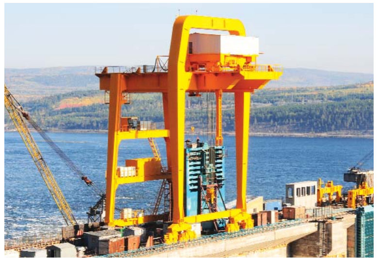
Рис. 8. Богучанская ГЭС. Кран козловой г.п. 500/250/10 т.
