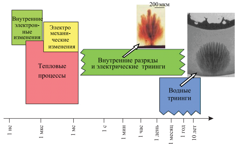
Рис. 2. Механизмы, приводящие к разрушению и пробоев изоляции, с отображением шкалы времени развития процессов [10] и фотографии водных трингов на вставках [20]
