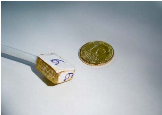
Рис. 3, а. Датчик індукції магнітного поля, встановлений на гідрогенераторі Київської ГЕС
