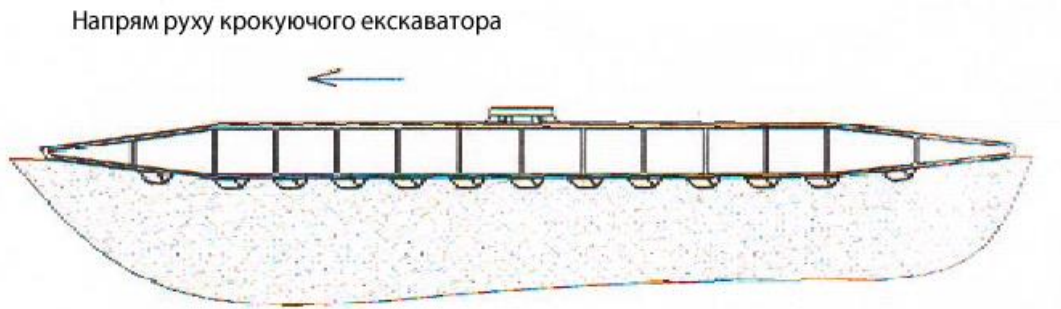
Рисунок 4 – Робота крокуючого механізму під час руху по пухкому ґрунту
