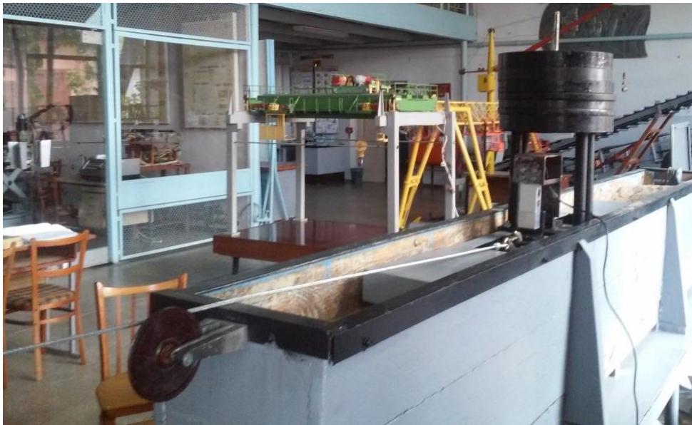
Рисунок 6 – Експериментальний стенд для дослідження процесу взаємодії опорної поверхні лижі екскаватора – драглайну з ґрунтом
