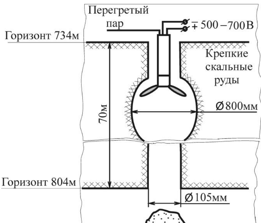
Рис. 1 – Технологическая схема термического расширения скважин
