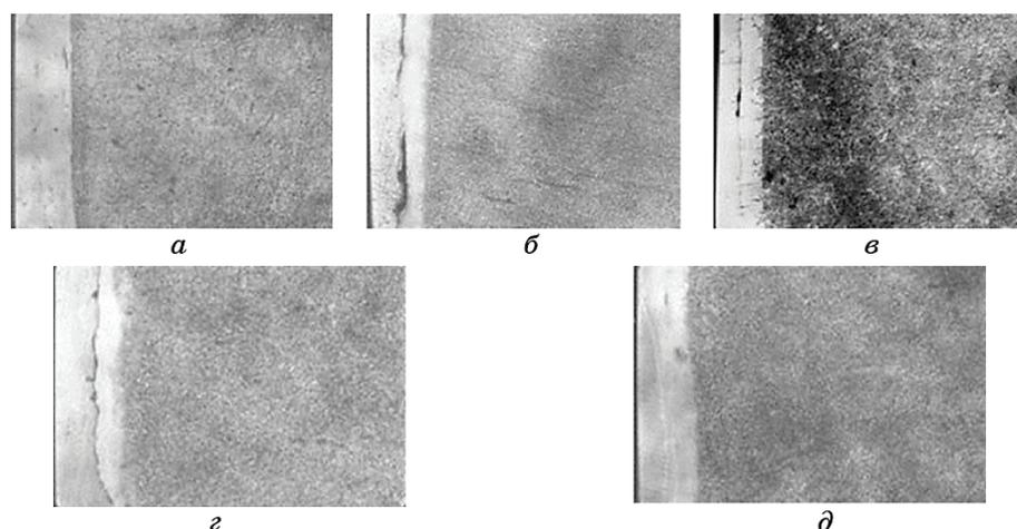
**Рис. 7.** Структура поверхностных слоёв стали 45 после ЭЭЛ никелем на воздухе на 3-м режиме (*а*) и в среде азота на 3-м и 5-м режимах, соответственно (*б*, *в*), и хромом, соответственно (*г*, *д*), в среде азота;  $\times 400$ ,  $C = 300$  мкФ.
