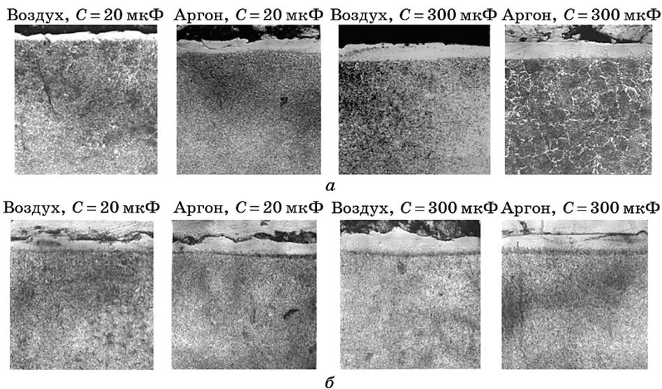
**Рис. 4.** Структура поверхностных слоёв стали 45 при ЭЭЛ электродами из АРМКО-железа (а) и стали 50 (б);  $\times 400$ .
