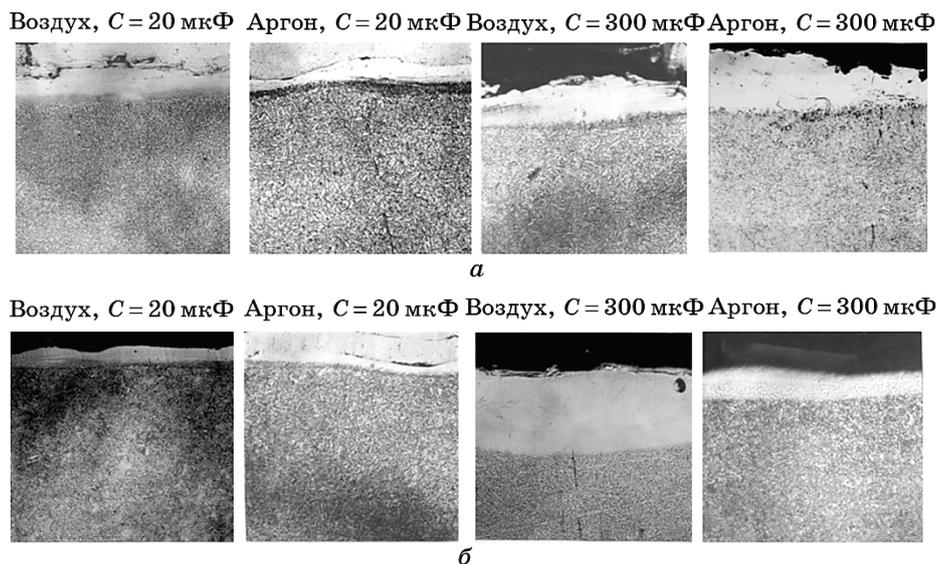
**Рис. 5.** Структура поверхностных слоёв стали 45 при ЭЭЛ электродами из стали 38ХНЗМФА (*a*) и 30Х13 (*b*);  $\times 400$ .
