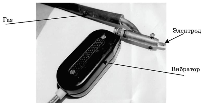
Рис. 1. Приспособление для подачи газа в зону легирования.
