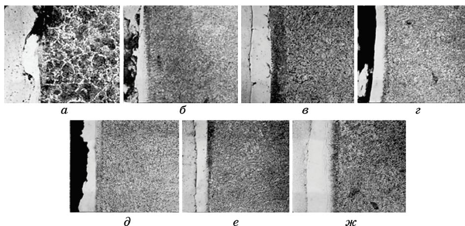
**Рис. 2.** Структура поверхностных слоёв образцов стали 45 после ЭЭЛ хромом на 1-м, 3-м, 5-м, 8-м режимах при  $C = 20$  мкФ (а-г) и 3-м, 5-м, 8-м режимах при  $C = 300$  мкФ (д-ж);  $\times 400$ .
