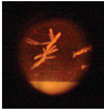
Рис. 6. Дендрити кристалів, одержаних методом FS за 6 годин (на підкладці шириною 6 мм); \times 4 . Пряма зйомка на цифрову фотокамеру через оптичний бінокулярний мікроскоп МБС-10.
