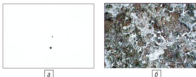
Рис. 5. Неметаллические включения (а, б) и микроструктура (в, е) образцов, вырезанных из колес Ø 957, ×400
