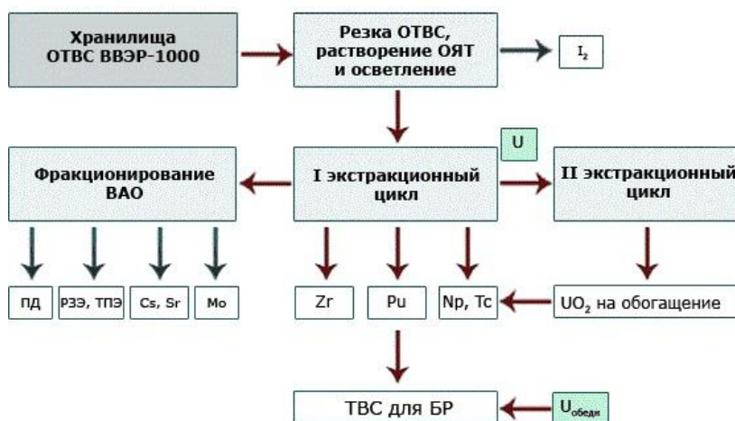
Рис. 6. Принципова технологічна схема регенерації ВЯП реакторів ВВЕР-1000 на заводі РТ-2 (Росія).
