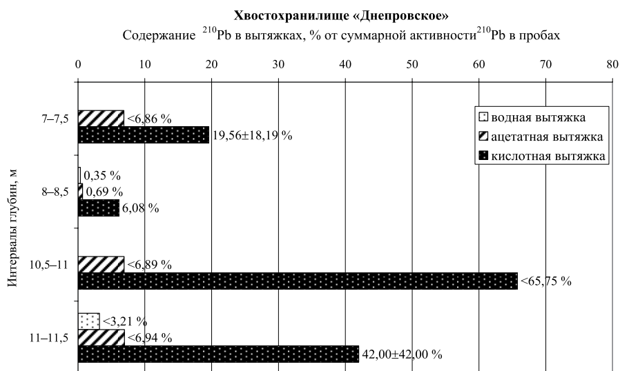
Рис. 4. Формы нахождения ^{210}\text{Pb} в разрезе хвостохранилища «Днепровское»
