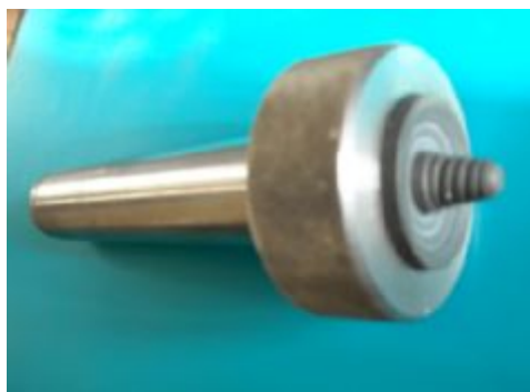
Рис. 1. Рабочий инструмент установки для наплавки трением с перемешиванием
