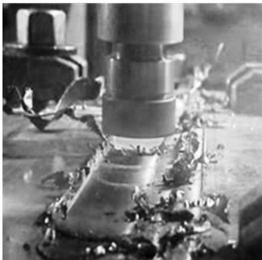
Рис. 2. Технология наплавки покрытия методом НТП
