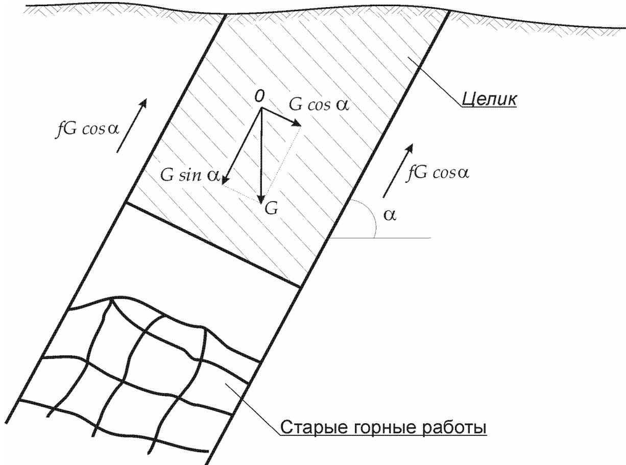
Рис. 4. Расчётная схема к определению условий образования провала на земной поверхности
