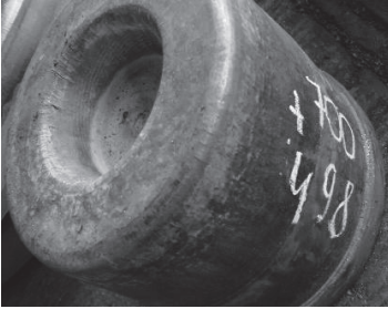
Рис.1. Внешний вид оправок пресса 10 000тн.
