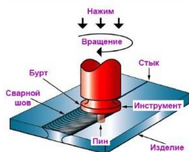
Рис. 2. Инструмент и принцип СТП
