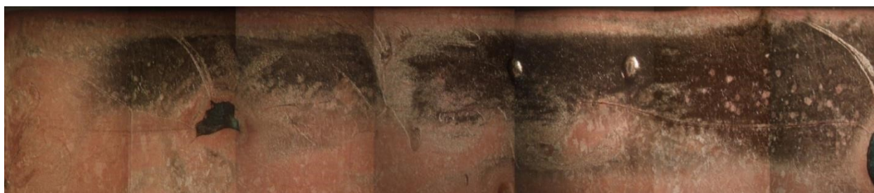
Рис. 6. Макроструктура наплавки меди марки М1 кристаллизатора МНЛЗ, полученной методом СТП \times 10
