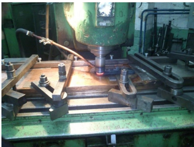
Рис. 5. Установка для наплавки и ремонта медных плит кристаллизаторов МНЛЗ
