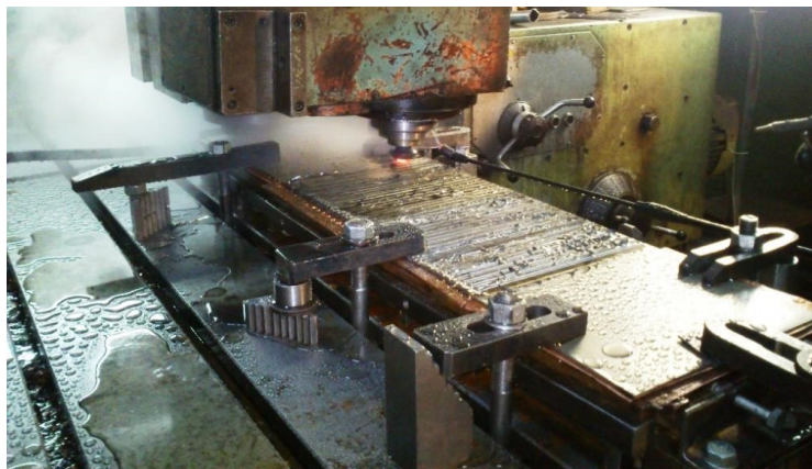
Рис. 7. Процесс нанесения 3 мм слоя никеля на медную плиту МНЛЗ методом НТП
