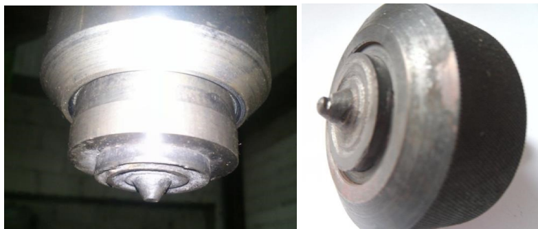
Рис. 4. Инструмент для СТП из «Киборита-2»
