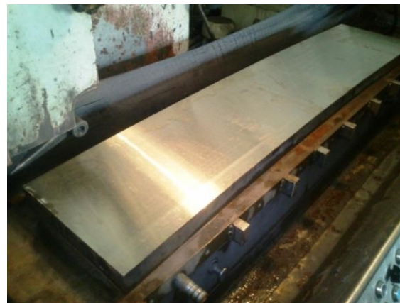
Рис. 8. Общий вид медной плиты с нанесенным никелевым покрытием после шлифовки
